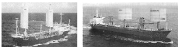
Ilustracija 7 Prve primjene krutih jedara na suvremenim trgovačkim brodovima
