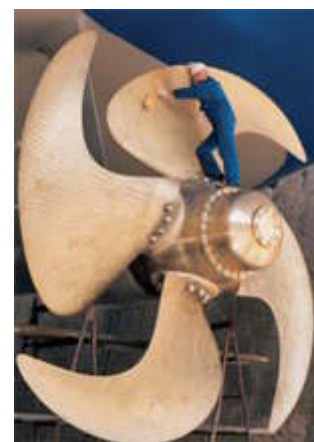
Ilustracija 3 Vijak upravljivog uspona uz koji se smanjuje potrošnja goriva do 10%
